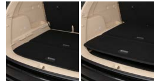
Podłoga bagażnika z wysokością regulowaną w dwóch położeniach
